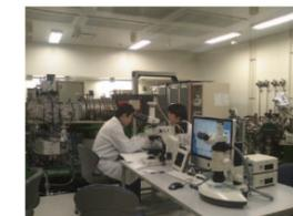
図2: イトカワ分析風景。窒素雰囲気グローブボックス中でイトカワ微粒子をサンプルホルダーに装着中。その後、手前の顕微鏡で観察後、後方の同位体顕微鏡で分析された。
