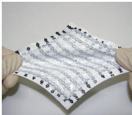
図1：伸縮性導体を配線にして実現されたゴムのよう伸縮自在な集積回路シート
