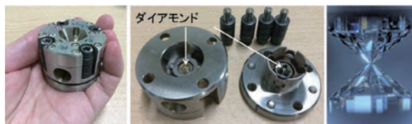
図2: レーザー加熱式ダイヤモンドアンビルセル
